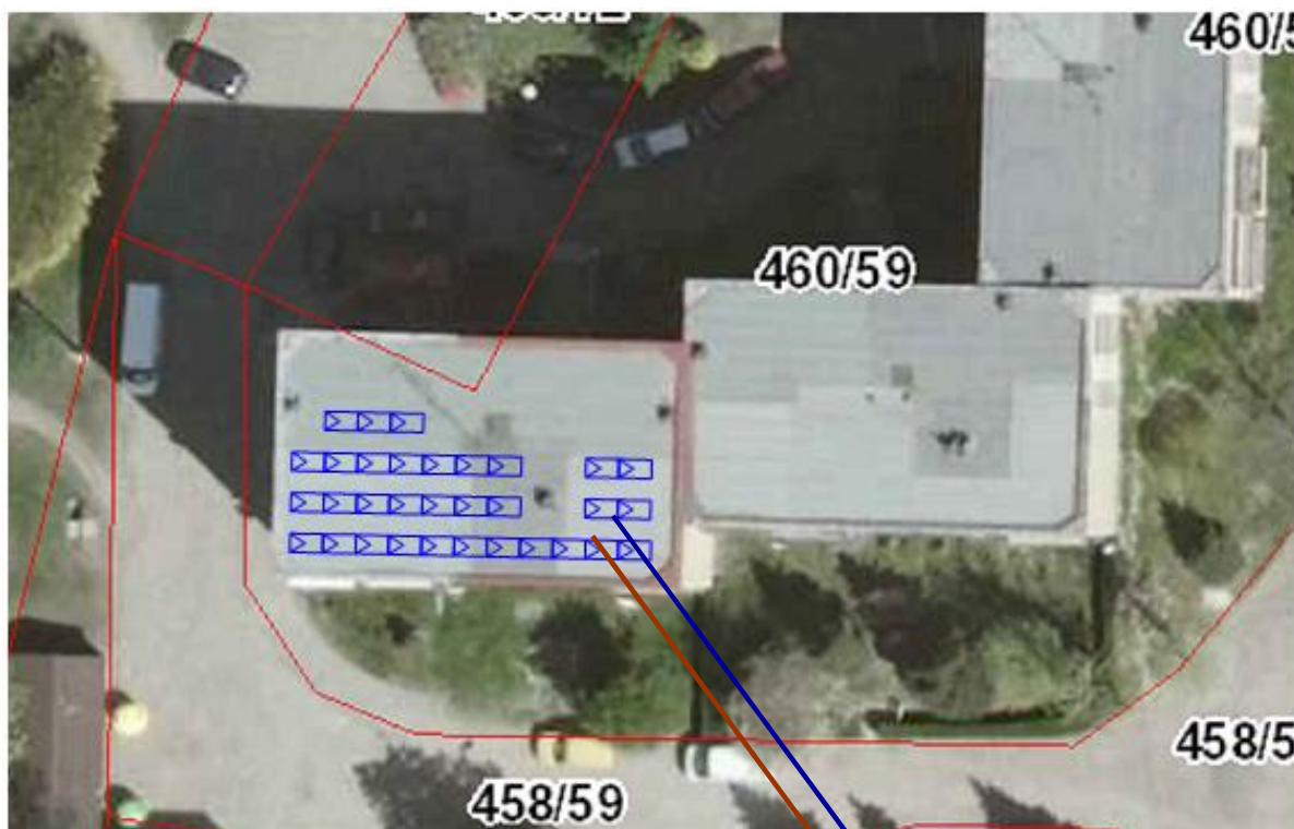
PROJEKTOWANA MIKROELEKTROWNIA FOTOWOLTAICZNA
